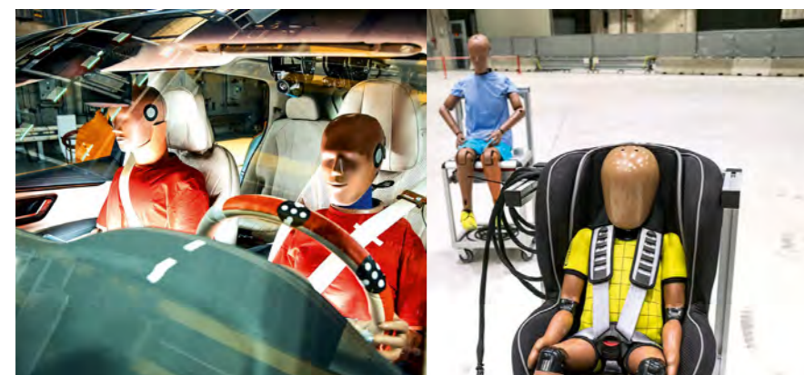
120 Dummies in 21 verschiedenen Varianten, darunter männliche und weibliche Testobjekte für Front- und Seitencrashes, kommen bei Mercedes-Benz zum Einsatz. Kinderdummys in sechs verschiedenen Größen simulieren junge Insassen vom Neugeborenen bis zum zehnjährigen Kind.
