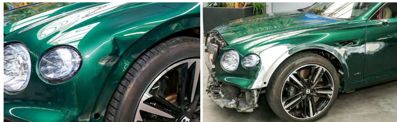
Oben: Hohe CO 2 -Ersparnis: Diese beiden Aluminiumschraubteile sind mit dem CBR-System reparierbar, müssen also nicht verschrotet und neu produziert werden. Siegbert Müller (l.): „Mit CBR-System und Alurepair Visar lassen sich Schraubteile nachhaltig und wirtschaftlich instand setzen.“
