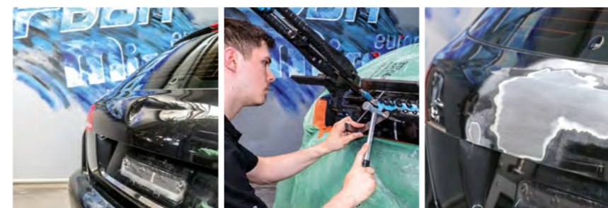
Richten einer A3 Heckklappe nur von außen mit minimalem Demontageaufwand, aber maximalem Benefit für alle Beteiligten.
